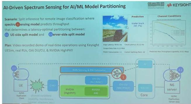
\* AI-RAN 환경에서 실시간 AI 기반 스펙트럼 감지를 바탕으로 한 적응형 머신러닝 모델 분할을 통해, 개인정보 보호, 지연 시간, 에너지 효율, 처리량 등 주요 성능 지표를 실시간으로 동적 최적화
